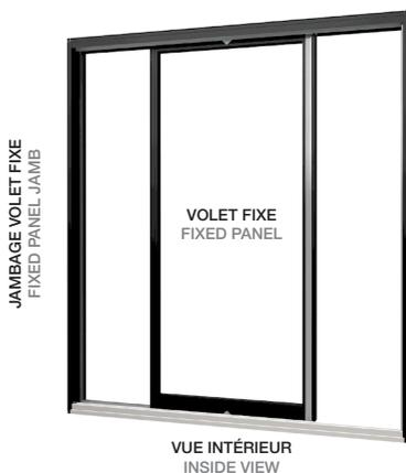
Insérer le volet fixe dans le cadre. Ne poussez pas le volet fixe en place immédiatement.
